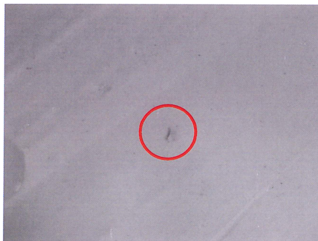
Foto 2: Untersuchungsmaterial SILIRUB Cleanroom, CH 200054801, Farbe weiß nach einer Inkubationszeit von 28 Tagen mit geringem Pilzwachstum (50fach vergrößert)
